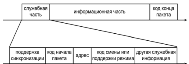
Рисунок 2 – Структура сообщения (пакета) в цифровом канале передачи сигналов управления БЛА от НПУ
